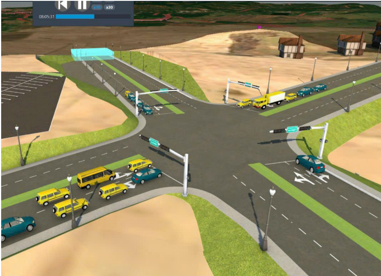
Hình 6: Mô hình 3D tổ chức giao thông tại nút giao trên mô hình BIM
