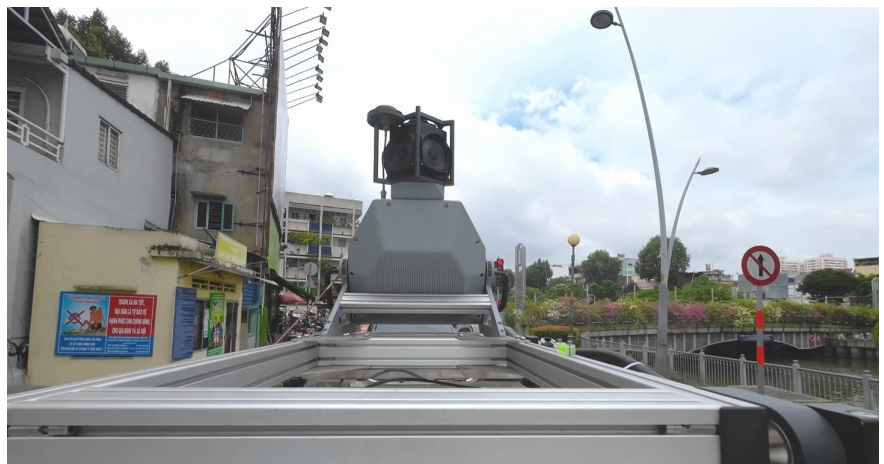
Hình 5. Sử dụng hệ thống Mobile Mapping để khảo sát đường giao thông 02 bên sông
