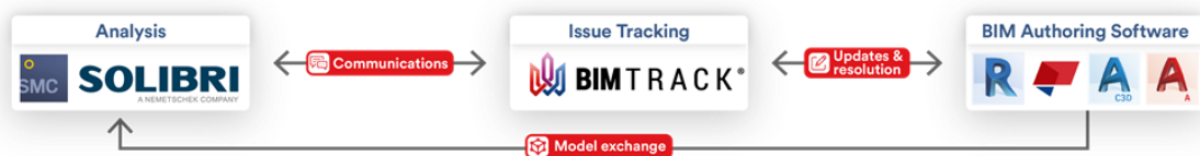
Hình 4. Phối hợp 2 chiều giữa ứng dụng tạo lập mô hình và phần mềm phân tích
