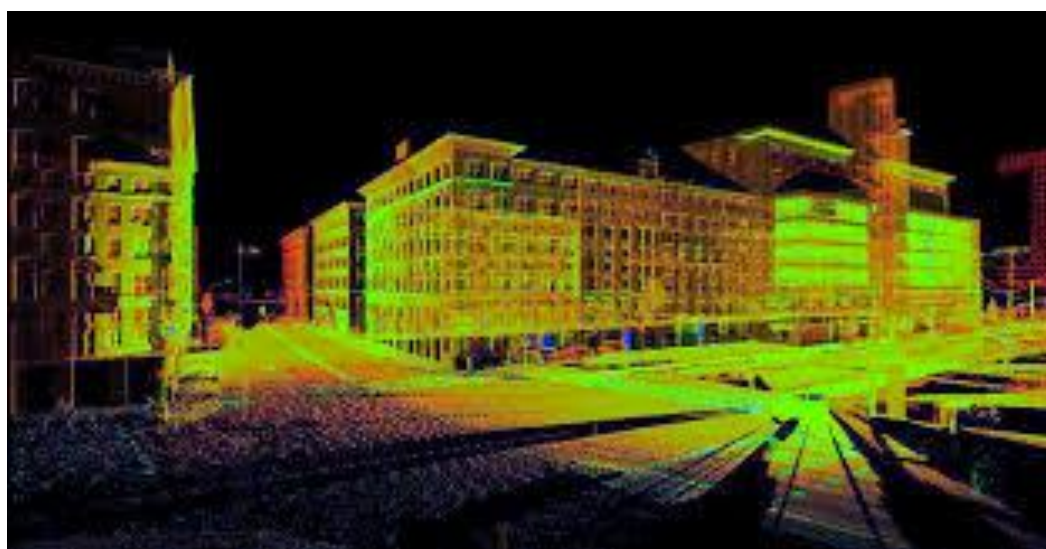
Hình 10. Đám mây điểm quét laser công trường
